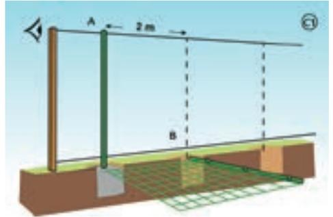
Couchez le panneau de grillage et fixez-le au sol sur le poteau B. Remplissez le deuxième trou de béton à prise rapide puis positionnez l'ensemble panneau + poteau B à sa place et fixez le tout au poteau A.
