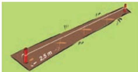
Creusez aux emplacements des trous de 30 cm de côté sur 50 cm de profondeur. Les poteaux doivent mesurer environ 50 cm de plus que la hauteur du grillage.
