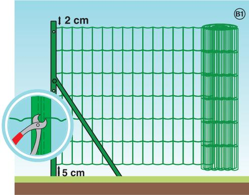
Déroulez le grillage jusqu'au poteau de tension (extrémité ou angle), tendez et fixez chaque fil horizontal à l'aide de clips inox agrafés en croix, au poteau (cf. B2).
