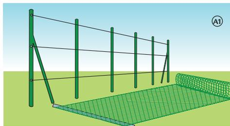
Fixez solidement la barre au premier poteau à l'aide de fils de tension. Installez progressivement le grillage contre l'armature, en le fixant de manière provisoire sur le fil supérieur. Tendez en attachant l'autre extrémité du grillage au prochain poteau d'angle ou d'extrémité. Pour cela, utilisez une nouvelle barre, puis coupez l'excédent de grillage.
